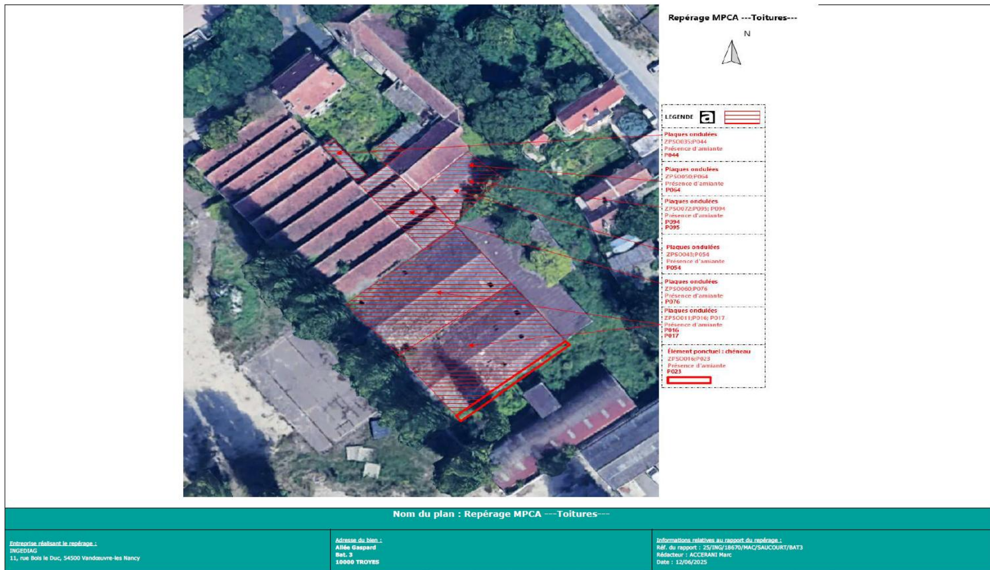
Figure 14 : Plan des prélèvements au niveau des toitures contenant de l'amiante dans le bâtiment 3
